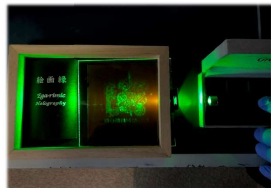
端面からの入射光がホログラムを再生する様子
